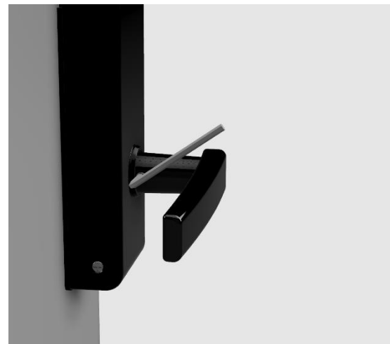
Figur 13 - Skru fast innvendig håndtak
